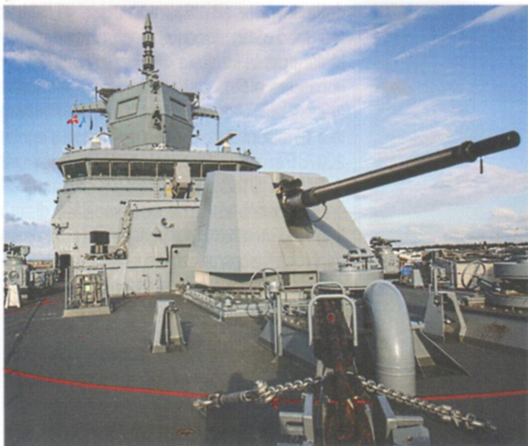
A sinistra: il simbolo del contenuto italiano sulle F-125: la torre Leonardo LW VULCANO da 127/64 mm e le torrette Leonardo HITROLE da 12,7 mm (visibili ai 2 lati). A destra: il complesso di lancio Mk-31 da 21 celle del sistema missilistico sup/aria RAM Block 1A.
