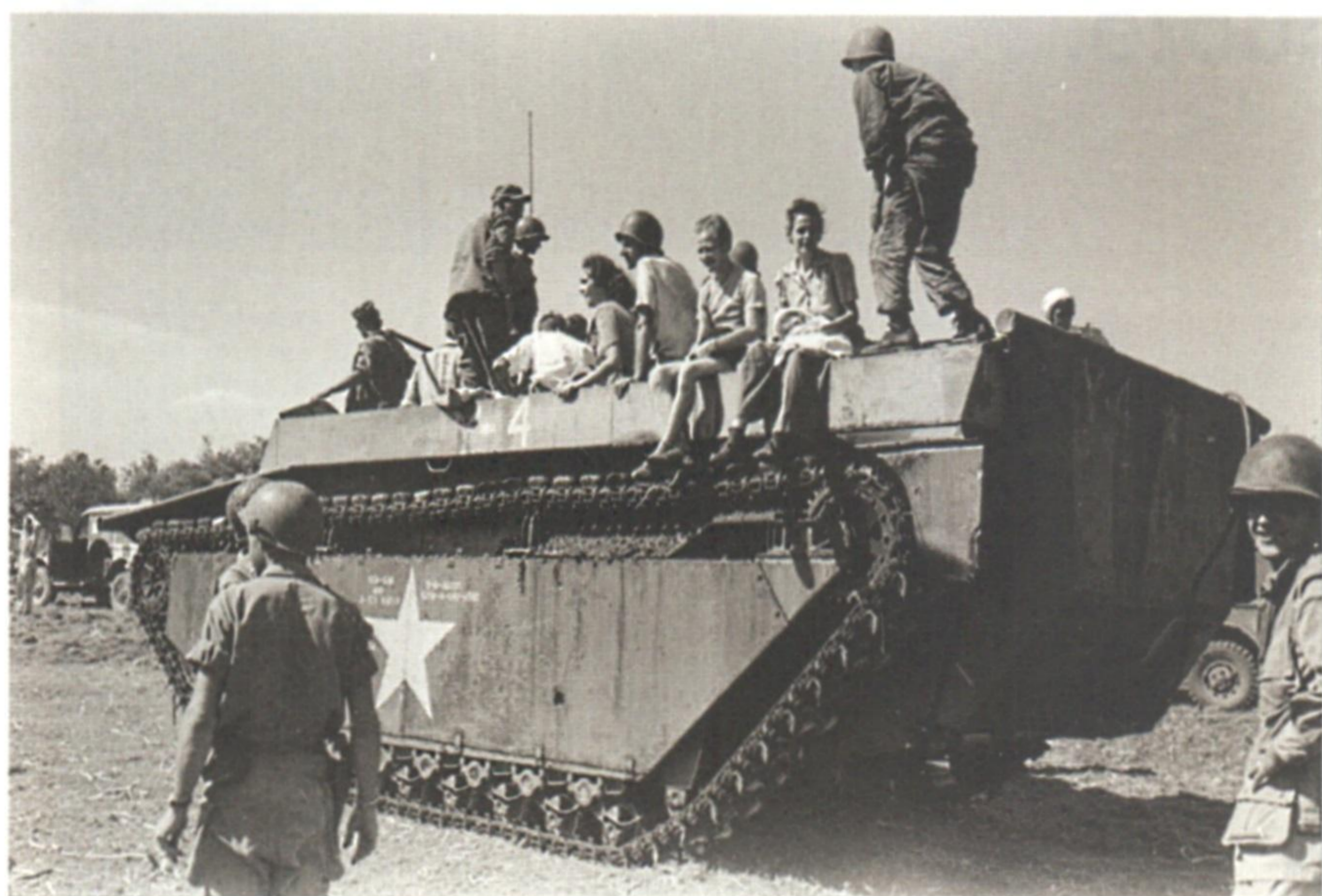
Un veicolo cingolato anfibio Amtrac LVT-4 con a bordo ex internati. Questo mezzo, lungo 7,37 m, largo 3,25 m, alto 2,64 m e pesante 13,7 t, capace di muoversi in acqua a 12 km/h, faceva parte di una grande famiglia i cui componenti sono stati prodotti complessivamente in 18.621 esemplari.
