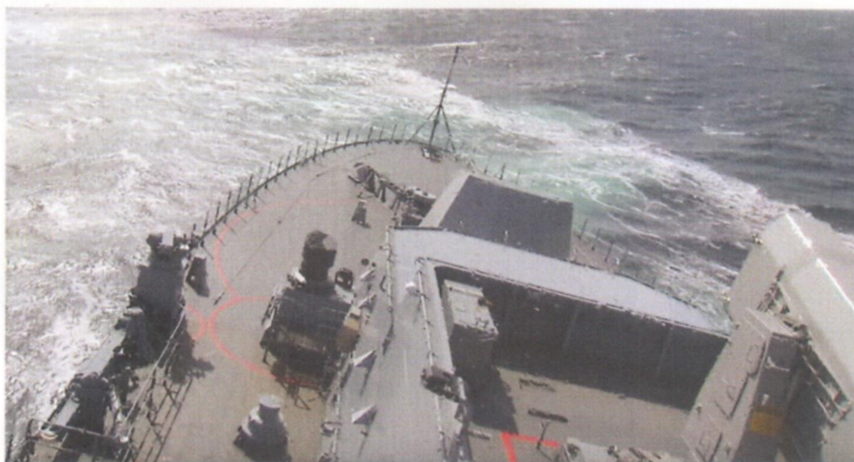
La BADEN-WURTTENBERG in virata stretta. Si distingue la torre Leonardo da 127/64 mm, un sistema missilistico sup/aria RAM, un lanciachaff MASS (nero) e una torretta Leonardo HITROLE da 12,7 mm (sull'estrema sinistra).
