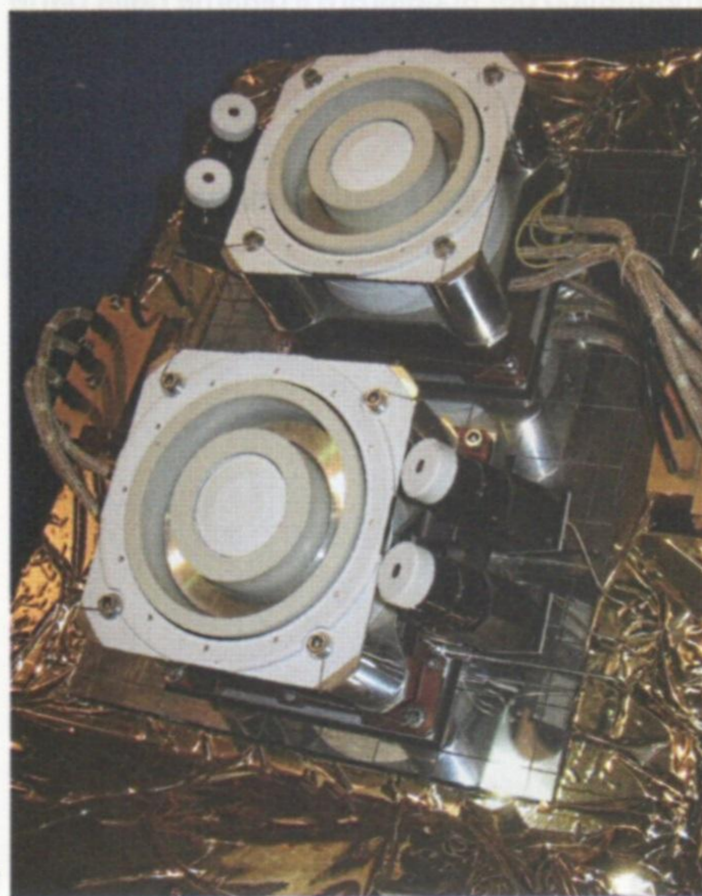
Sopra: il thruster ad effetto Hall SPT-140 della russa Fakel EDB. Sotto: il PPS-1350 ad effetto Hall è stato oggetto nel luglio 2015 di un consistente ordine da parte di SSL (Space Systems/Loral) con forniture dal 2016 al 2018 e ulteriori opzioni. Il thruster è in grado di effettuare manovre di sollevamento orbitale parziale e mantenimento della posizione per tutta la vita del satellite. (Foto: SNECMA)
