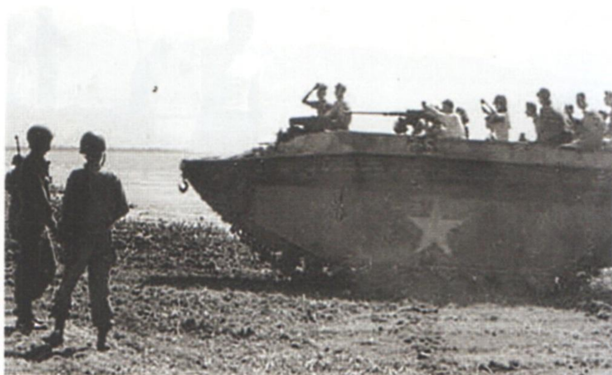
Un Amtrac LVT-4 in movimento probabilmente sulla spiaggia di Hamatid con a bordo ex internati. Ben evidente la mitragliatrice Browning M-2 da 12,7 mm.
