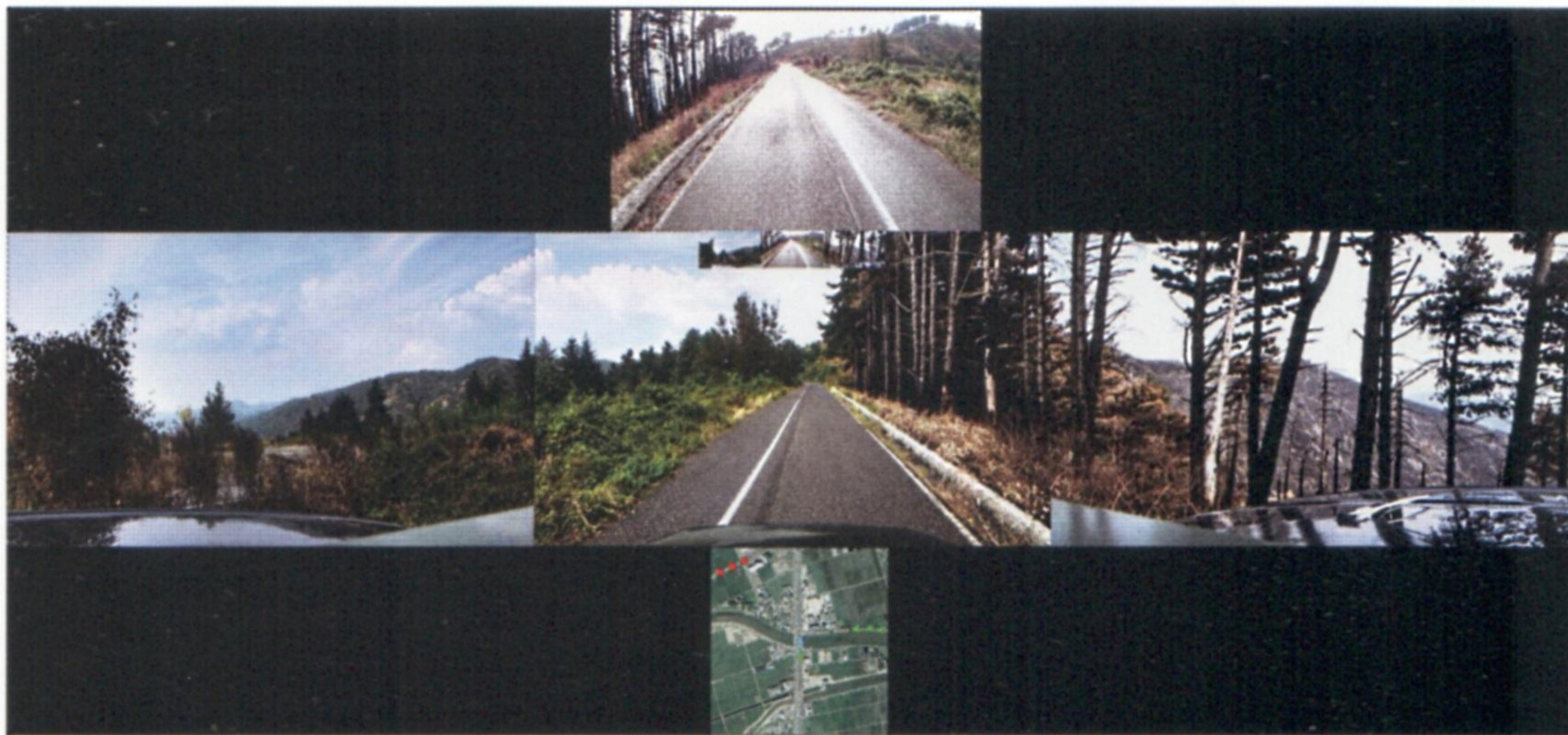
Una ricostruzione di ciò che vede nell'Helmet-Mounted Display un pilota di un mezzo dotato del sistema HORUSS; in grande la visione anteriore su 180°, in alto la vista della telecamera posteriore e in basso la schermata del BMS. (foto: Angelo Podestà)
