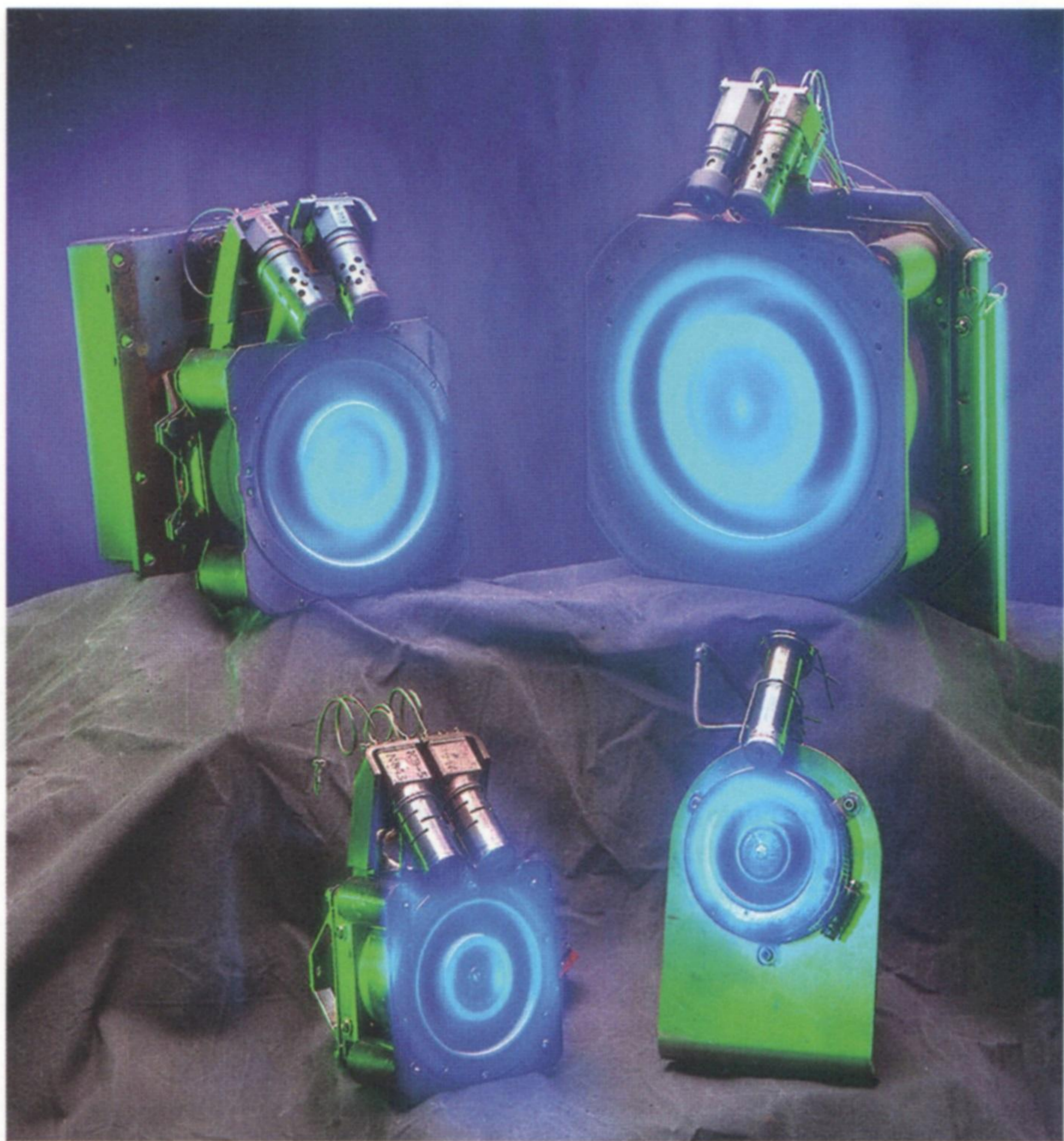
Vari modelli di thruster di produzione russa. La Russia, allora Unione Sovietica, è stata la prima utilizzatrice su larga scala di thruster a ioni sui suoi satelliti.
