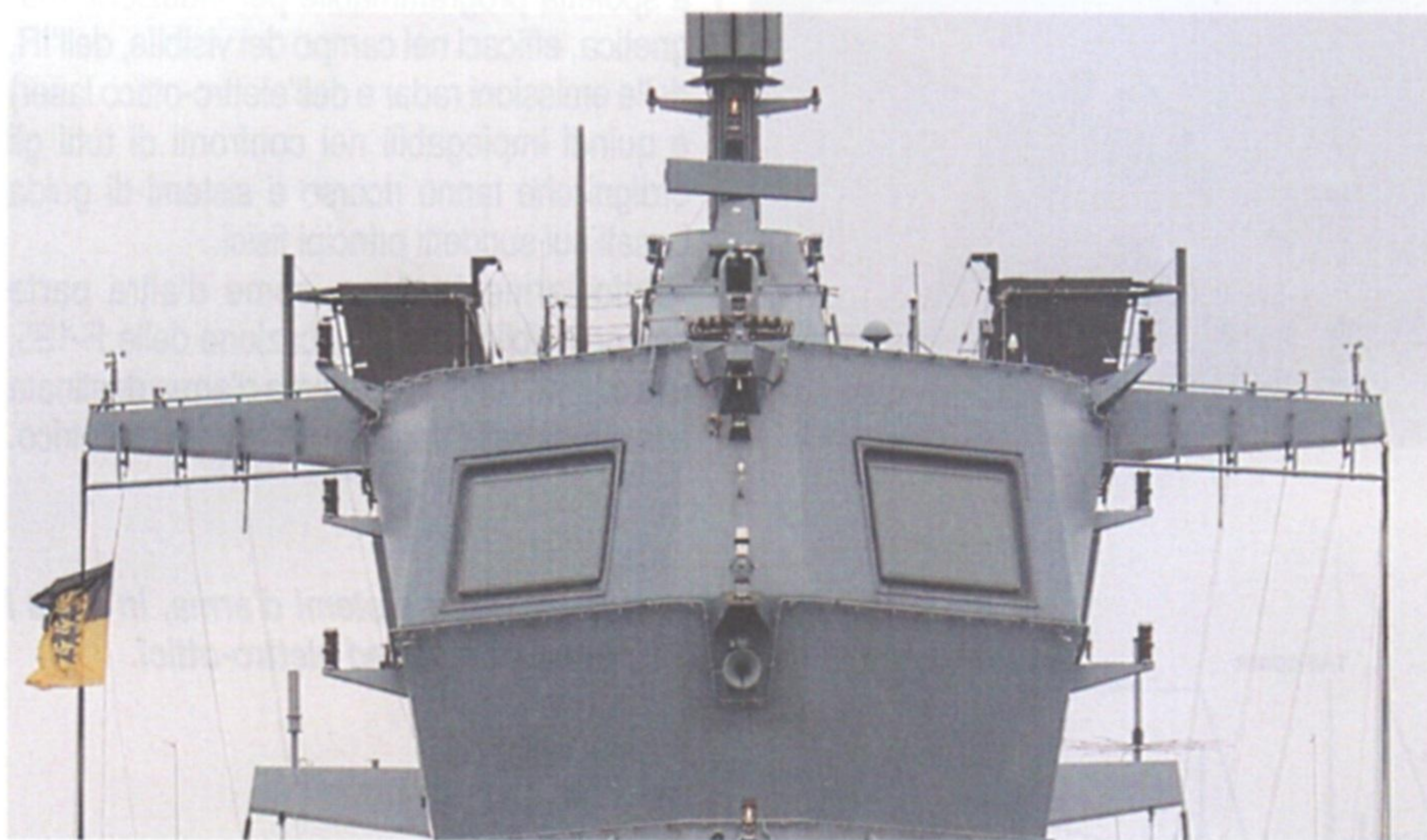
Sopra: 2 delle 4 antenne planari fisse di forma quadrata del radar polifunzionale AESA TRS-4D/NR. A sinistra sono elencate le sue numerose funzionalità operative. All'inizio dell'alberatura si vede l'antenna dell'IFF.
