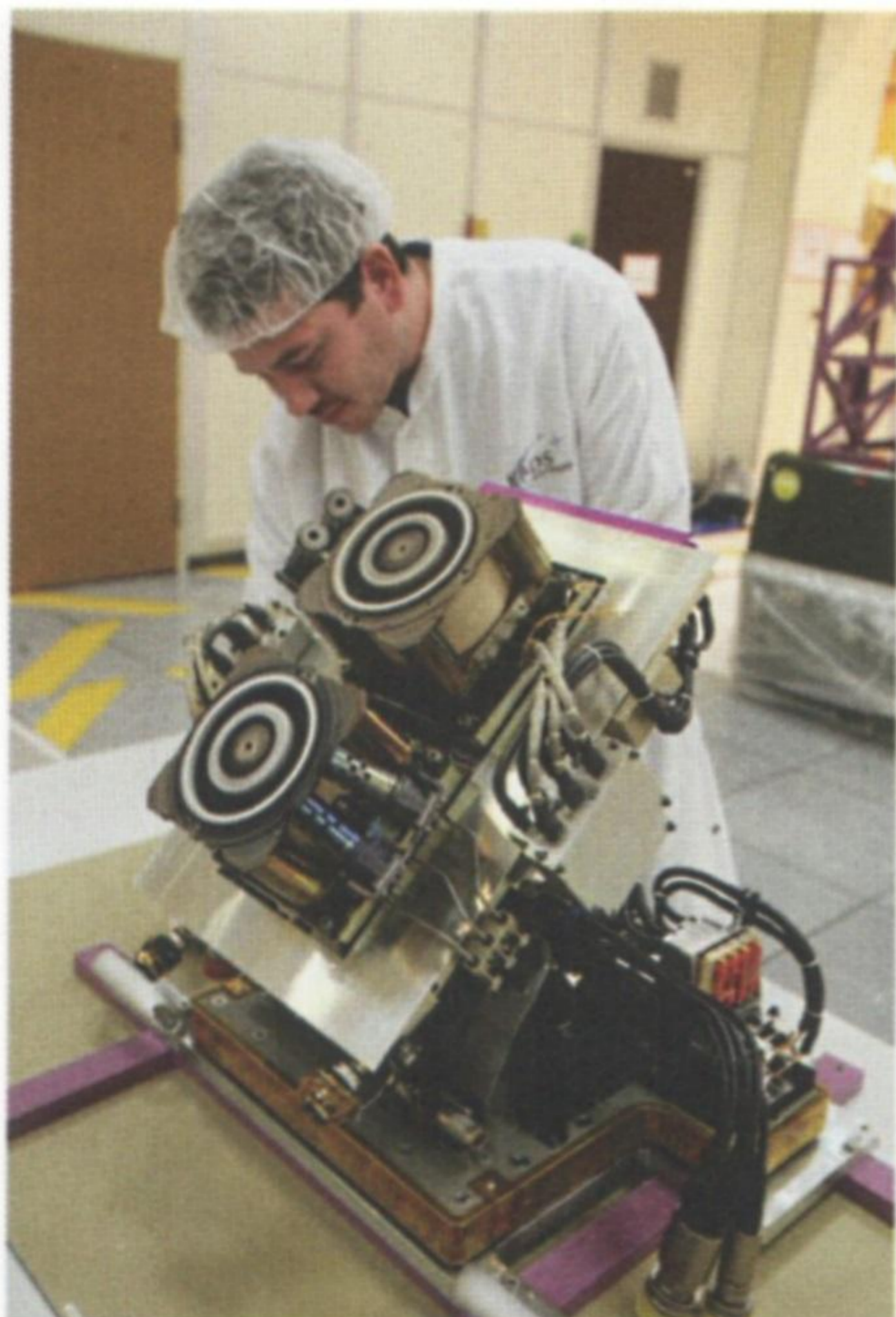
A sinistra: montaggio di una coppia di thruster della SNECMA (SAFRAN), uno dei maggiori produttori al mondo di propulsori di tale categoria. (Foto: SNECMA). A destra: un thruster a plasma SNECMA PPS1350 durante i test in laboratorio. (Foto: SNECMA)
