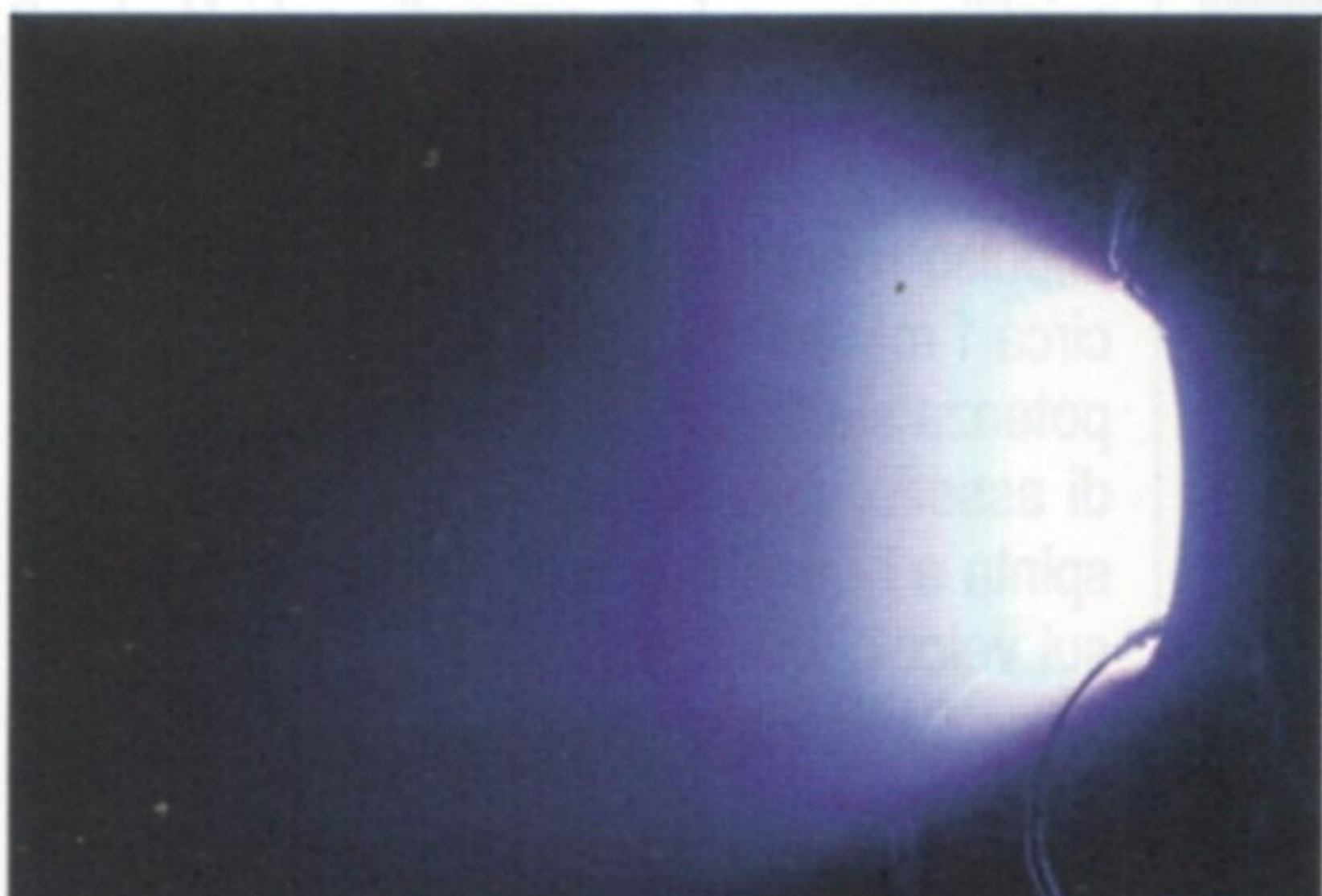
Prove in laboratorio dell'AF-MPD, sviluppato dall'italiana Alta per il sollevamento dell'orbita e la manovra di grossi satelliti. (Foto: Alta SpA)
